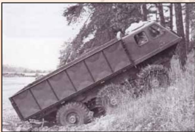
Prototype PV2 leek al meer op de definitieve uitvoering. De zijkanten van de laadbak waren dubbelwandig uitgevoerd en voorzien van rubber afdichtingsprofielen.
