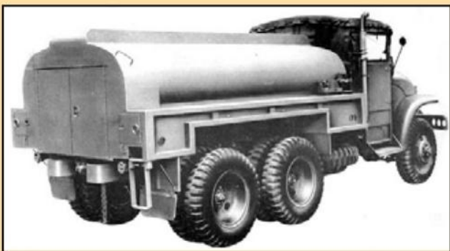
◀ en ▲ M217 Truck, Gasoline Tank. Er waren slechts enkele kleine uiterlijke verschillen met de M222 Truck, Water Tank ▼
