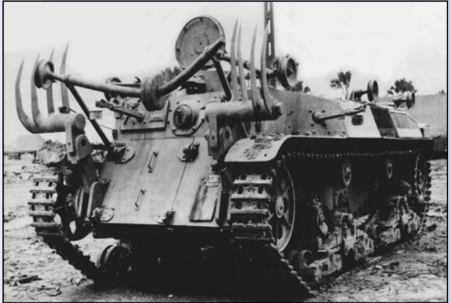
De voorkant van de SS-Ki ziet er met die twee vorken indrukwekkend en zelfs angstaanjagend uit. De vorken zijn bestemd voor het ruimen van mijnen en het rooien van boomstronken. Op de wieltjes bovenop de tank kan een brug worden meegevoerd.
