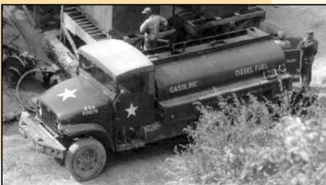
◀ M217 Truck, Gasoline Tank . de vuldeksels boven op de tank zijn duidelijk te zien
