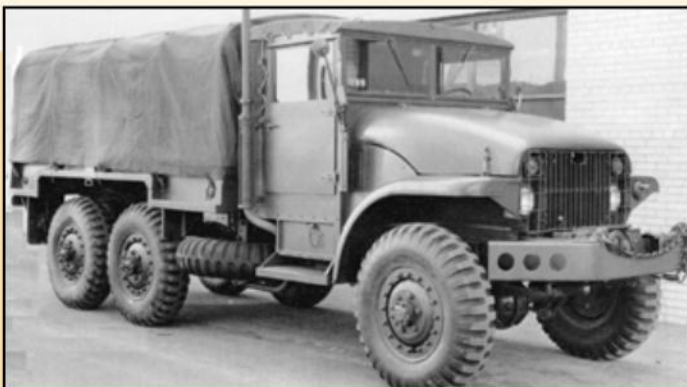
De voorproductie voertuigen waren op enkele punten aangepast. De bumper haf gebogen uiteinden en uitsparingen t.b.v. gewichtbesparing. Ook de wielkasten zijn iets anders dan die van de pilot uitvoering.
